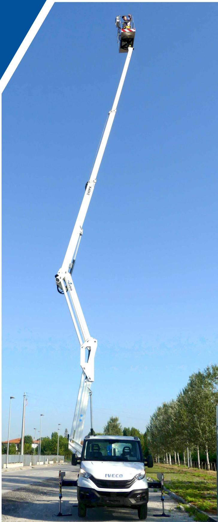
La nacelle élévatrice GSR B240PX introduit une nouvelle caractéristique dans le concept de double articulation “up-and-over”.
