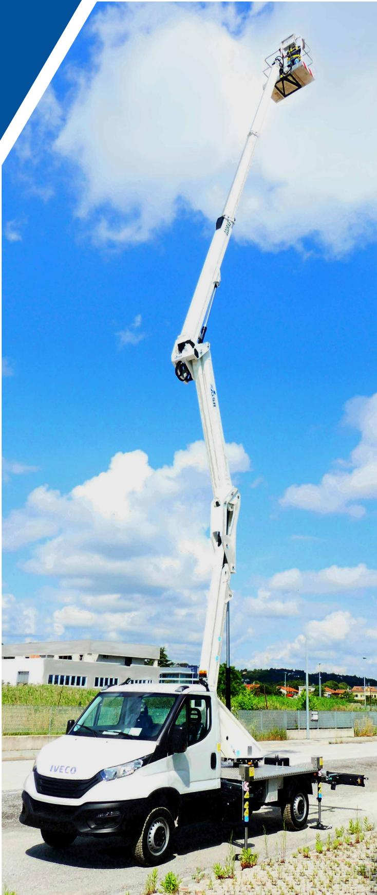
La nouvelle nacelle élévatrice B220PXE intègre la double articulation “up-and-over” avec un bras télescopique innovant et avec un panier monté en bout.
