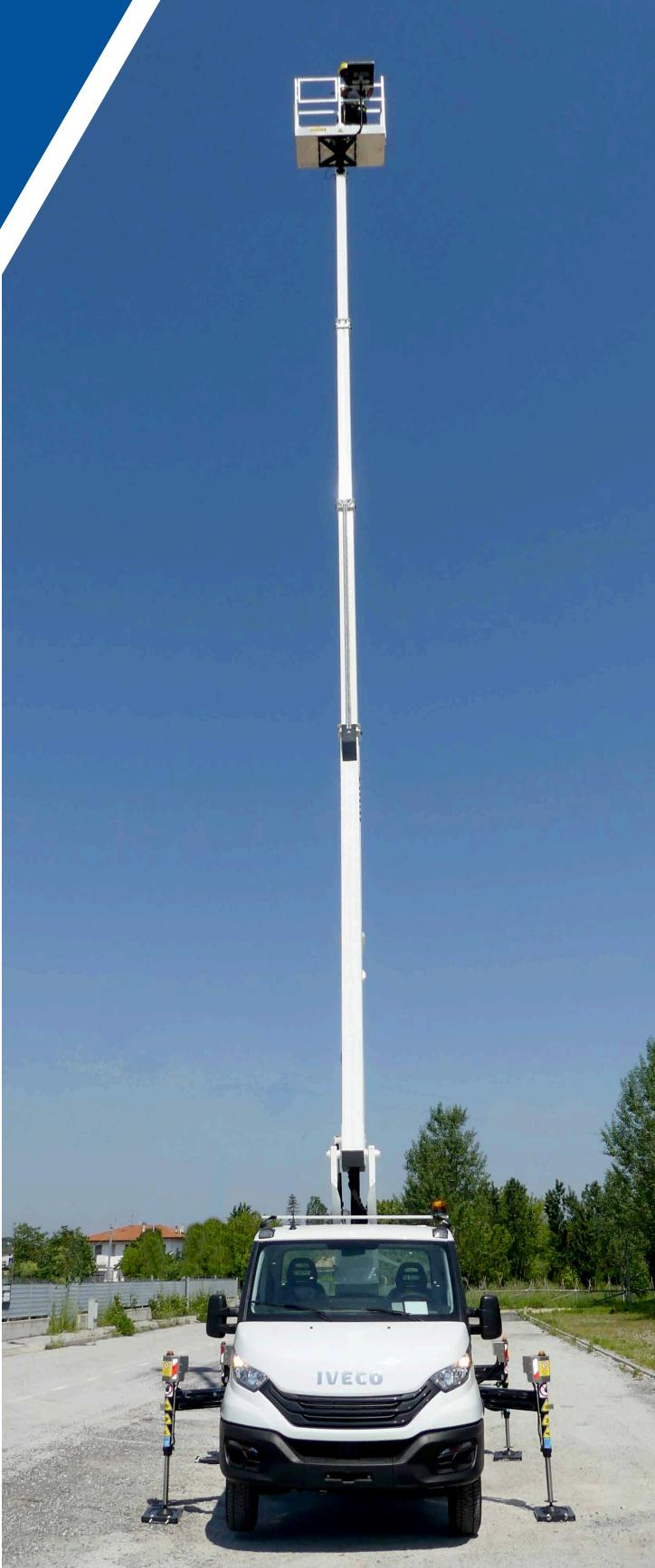
La nacelle GSR B230T4 renouvelle ses performances dans la catégorie des 23 mètres de hauteur sur véhicules légers.
