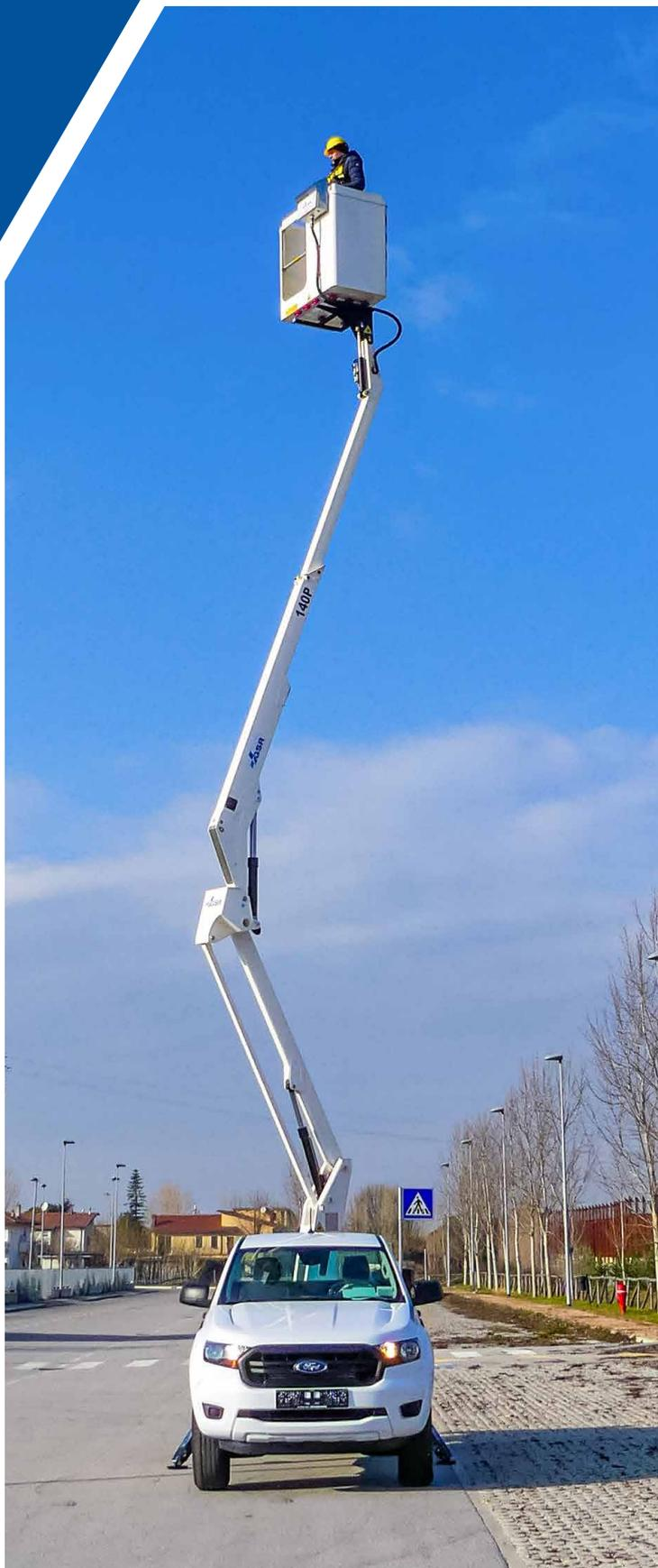
La nacelle élévatrice GSR E140P combine la rigidité et la robustesse typiques de la production GSR avec la polyvalence du bras articulé et télescopique. Le résultat est une machine compacte et fiable.
