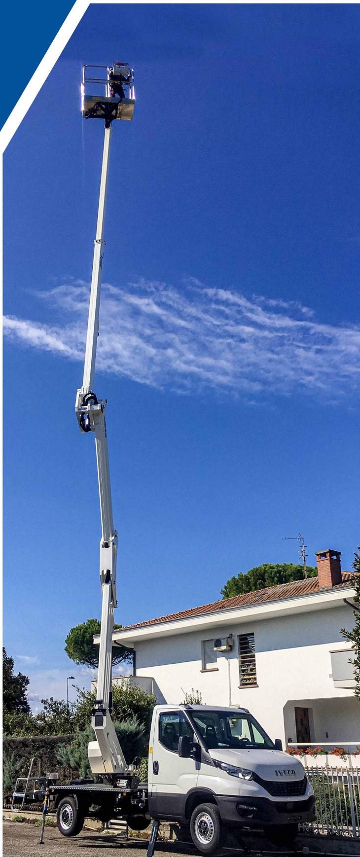
La nacelle élévatrice articulée GSR B200PX avec double pantographe, permet d'atteindre un déport horizontale maximum de 9 mètres, gardant la stabilisation dans le gabarit et étant particulièrement compacte.
